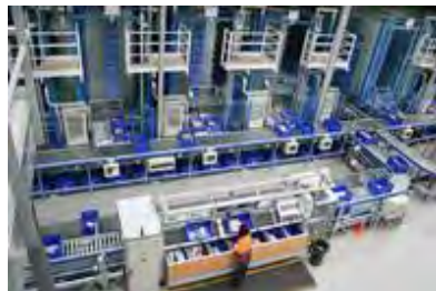
Slika 3.45. Sistem za automatsko komisioniranje kapaciteta dve do pet kutija u sekundi
