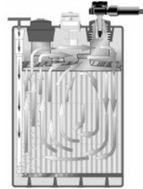
Slika 4.4. Nova generacija baterije sa cirkulišućim elektrolitom.
