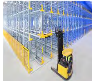
Slika 3.10 Opsluživanje kanalnog regalnog skladišta regalnim liftom.
