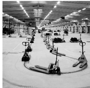
Slika 4.23. Automatizovan sistem sa podnim vučnim lancem sa mogućnošću formiranja pufera kombinovani sa viljuškastim podiznim kolicima
