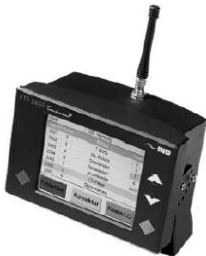
a) Terminal za komisioniranje vozilo
