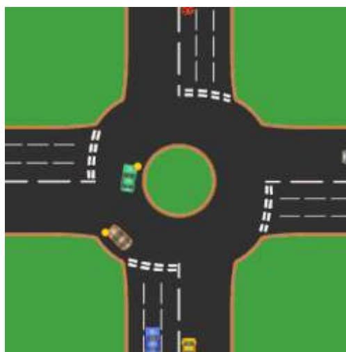
Slika 3.28. Dijagram kretanja unutar kružnog toka u državi u kojoj se saobraća levom stranom puta
