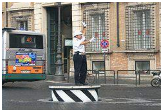
Slika 3.25. Kontrola saobraćaja u Rimu, Italija. Ovaj podijum za kontrolu saobraćaja može se uvući nazad na nivo puta kada nije u upotrebi.
